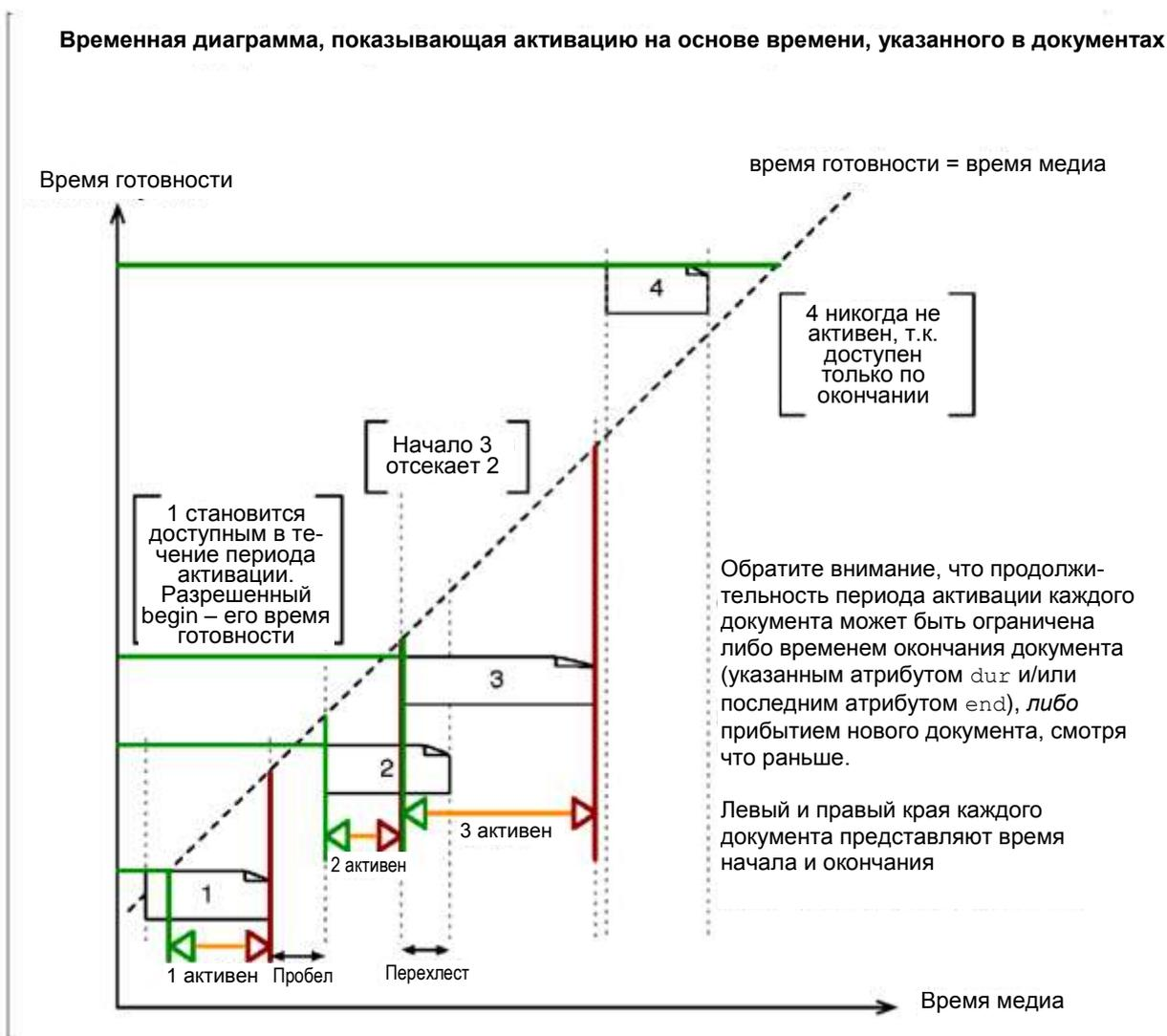
**Рис. 7: Схема, показывающая время начала и окончания документов с явной синхронизацией**
